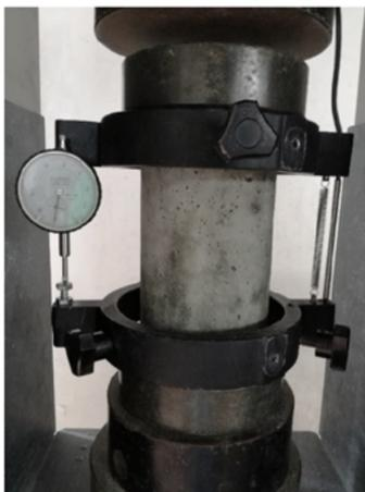
Figura 2: Compresómetro con micrómetro longitudinal mecánico.
