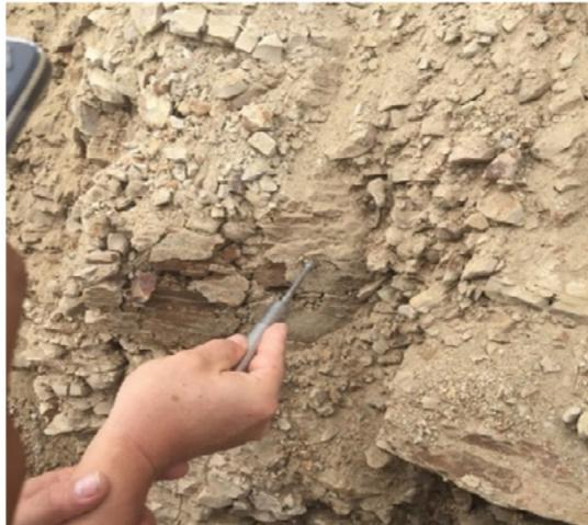
Figura 2: Lutitas fuertemente diaclasadas y fracturadas.
