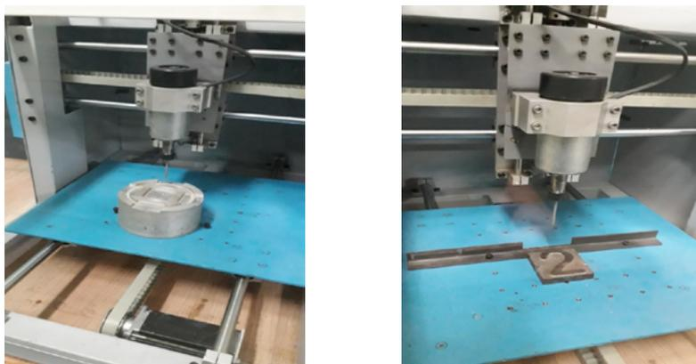
*Figura 11 Piezas de diferentes geometrías maquinadas en la fresadora CNC a escala. A la izquierda pieza 1 y a la derecha pieza 2. Fuente: Autor.*
