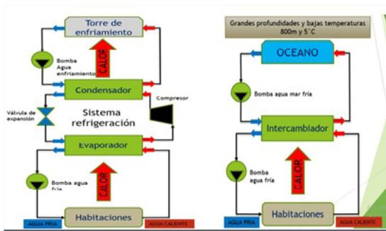
Figura 1.- a) Sistema de aire acondicionado convencional. b) Sistema SWAC con agua de mar (Elaboración propia).
