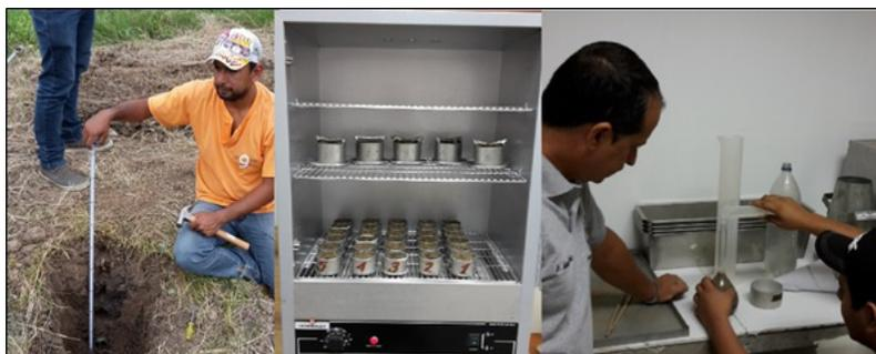
Figura 4. Extracción de muestras en calicatas y procesamiento en el laboratorio para la determinación de la densidad real, densidad aparente y porosidad.
