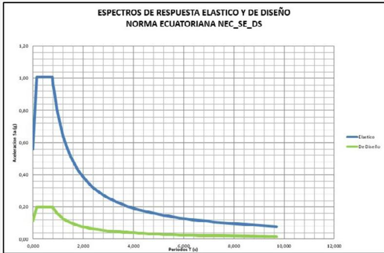
Figura 6: Espectros de respuesta elástica y de diseño
