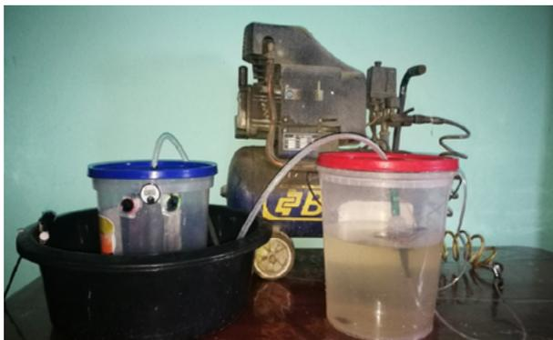
Figura 2. Ensayo experimental a base de la simulación de un ambiente salino
