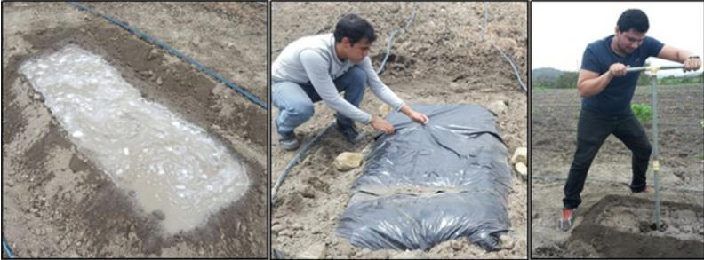
Figura 3. Preparación y extracción de muestras para determinar la Capacidad de Campo del suelo.
