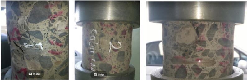
Figura 3: Ensayos de resistencia a la compresión de muestras de columnas y viga, Fuente: los autores
