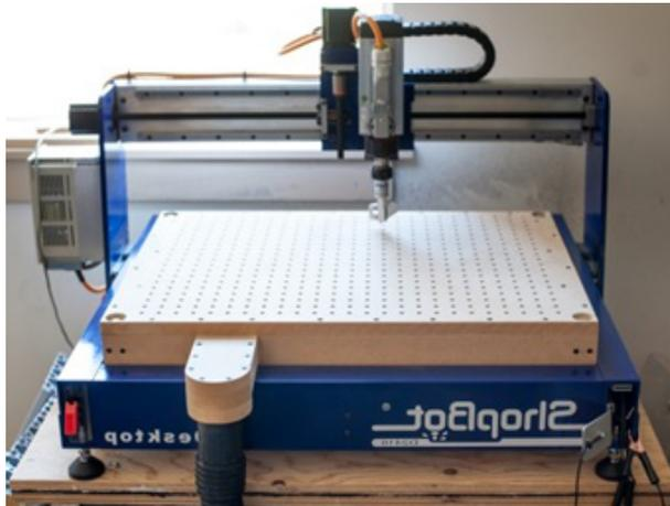
Figura 1 Máquina CNC de 3 ejes a escala. Fuente: Steven, 2010.
