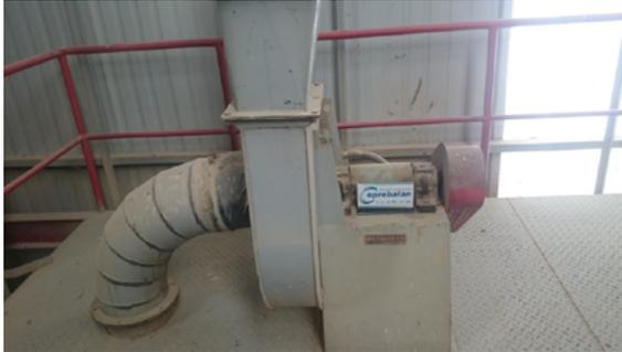
Figura 8 - Ducto de transporte para selección y distribución de materia prima procesada. Fuente: Empresa Molinera "COPROBALAN".
