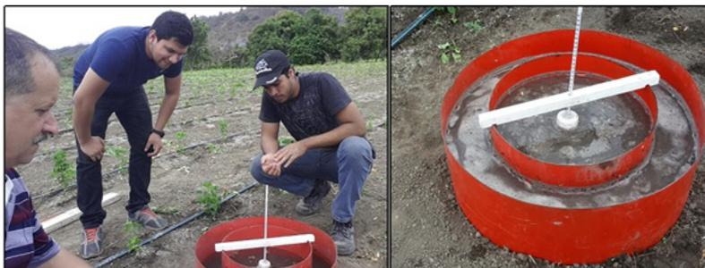
Figura 4. Determinación de la Velocidad de Infiltración del Suelo por el Método del Infiltrómetro de doble anillo.
