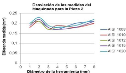
Figura 13 Valor del error dimensional máximo en el maquinado de la pieza 2.
