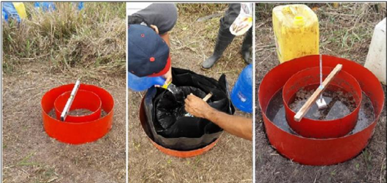
Figura 3. Colocación de los Anillos de Infiltración para la determinación de Velocidad de Infiltración del suelo en uno de los puntos de observación.
