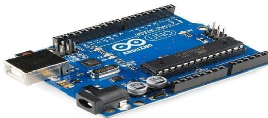
**Figura 3:** Placa Arduino convencional
