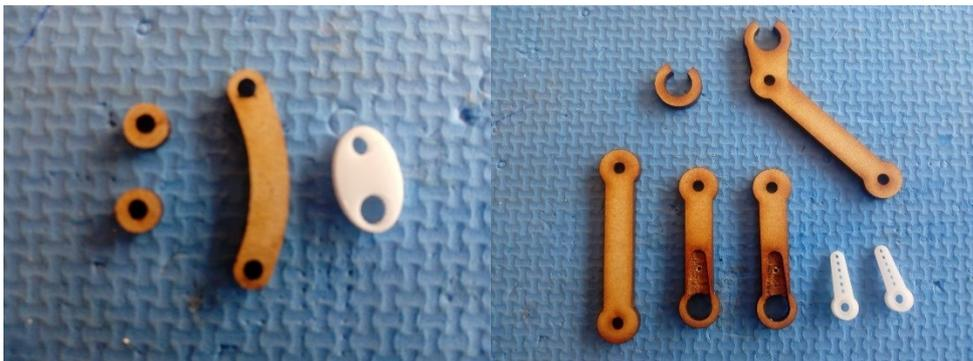
**Figura 2:** Piezas del robot reloj
