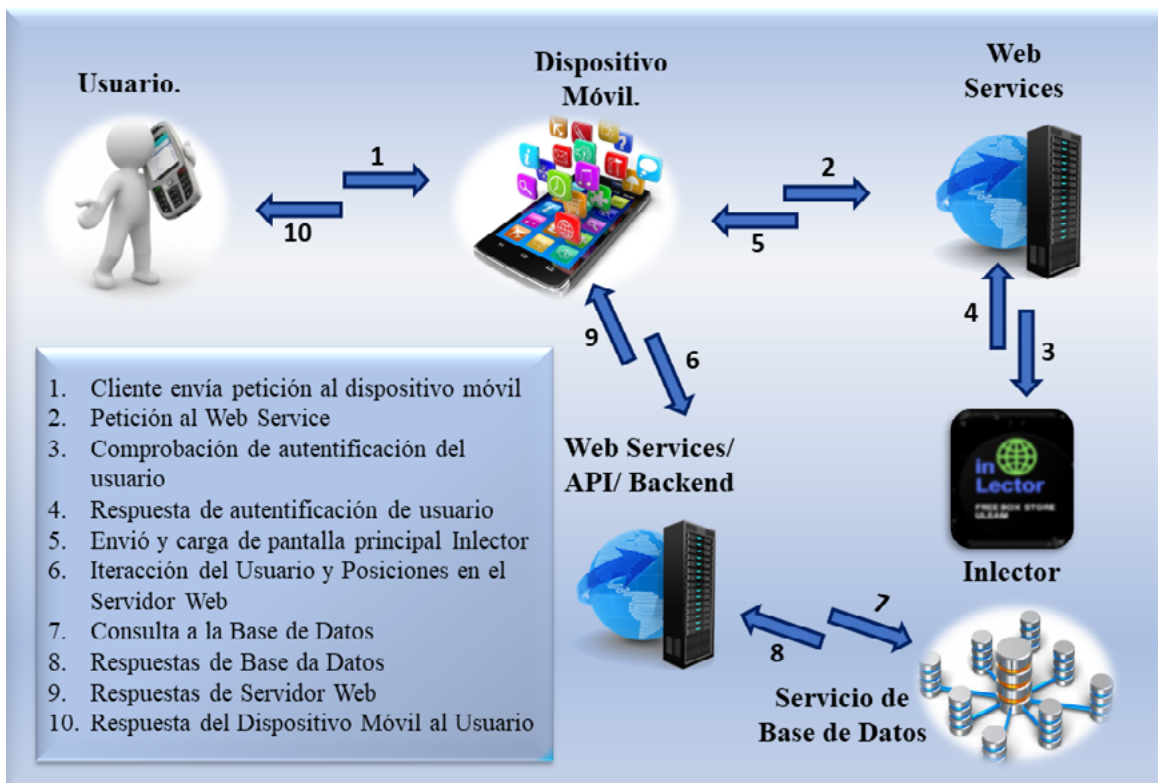
Ilustración 32. Arquitectura total de la aplicación móvil "InLector".
