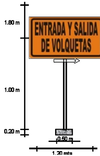
Ilustración 41: Señalética vial: entrada y salida de volquetas
