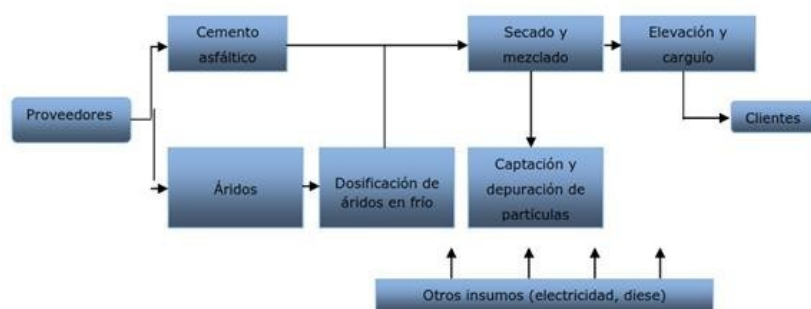
Ilustración 21: Diagrama de flujo del proceso de producción de la mezcla asfáltica
