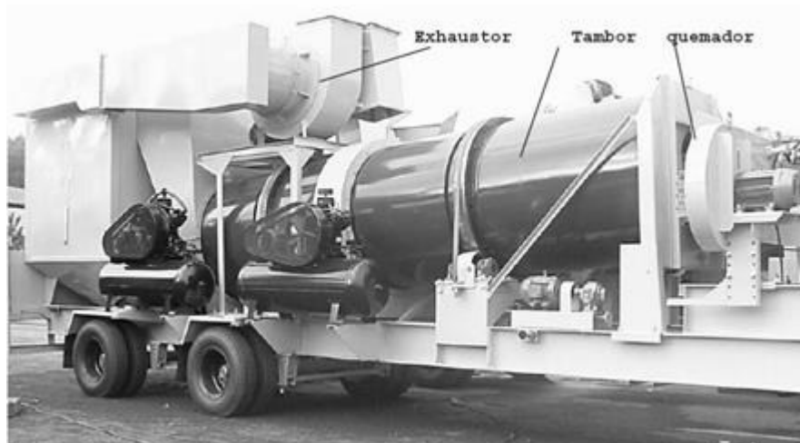
Ilustración 12: Vista exterior de un tambor secador-mezclador
