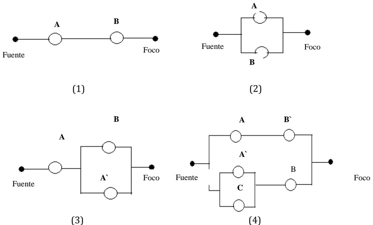
Sean A y B interruptores abiertos, A y A' interruptores tales que el primero está activado y el segundo desactivado. Los interruptores A y B se pueden conectar con un alambre, logrando obtener circuitos en serie o en paralelo como demuestran los gráficos 1 y 2.
