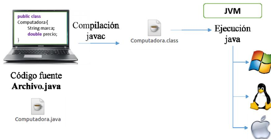
Figura 1 Proceso de ejecución de una aplicación Java
