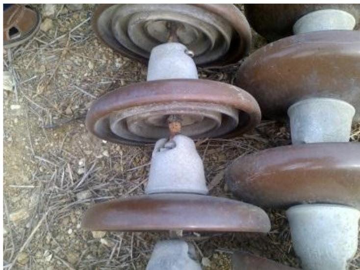
*Figura 18. Muestra de los aisladores deteriorados por causa de la contaminación*
