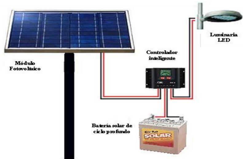
Figura 12. Componentes y circuito eléctrico de la luminaria fotovoltaica
