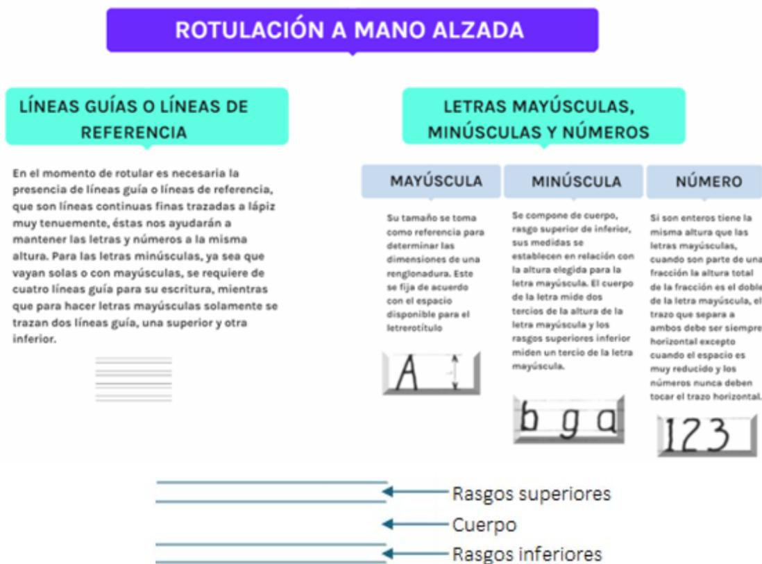
Ilustración 2. Clasificación de las líneas guías en la rotulación a mano alzada
