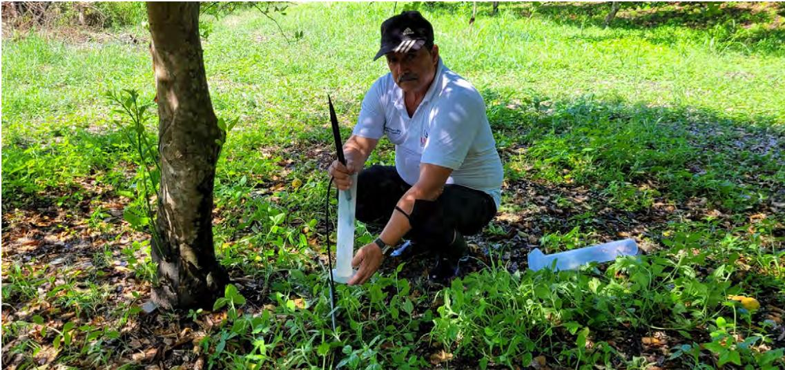
6- Calcular el caudal medio de cada pareja formada por los dos distribuidores contiguos, lo que originará 16 caudales medios. Se obtiene al dividir cada volumen recogido en la probeta por el tiempo de medición y se expresa en litros por hora (l/h).
