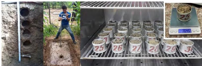
Densidad real, densidad aparente y porosidad: se determinaron a partir de muestras extraídas en una calicata efectuada en el suelo en cada uno de los 14 puntos de estudio (primera imagen de la figura 2) y procesadas en el laboratorio según lo establecido en la norma ISO 11272: 2017 (ISO, 2017).
