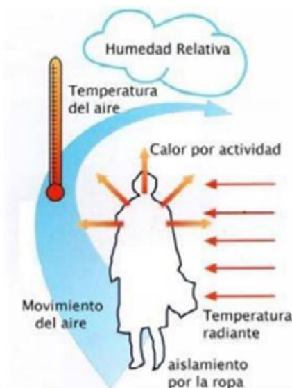
Figura 98. Principales Factores y parámetros que afectan al Confort Térmico
